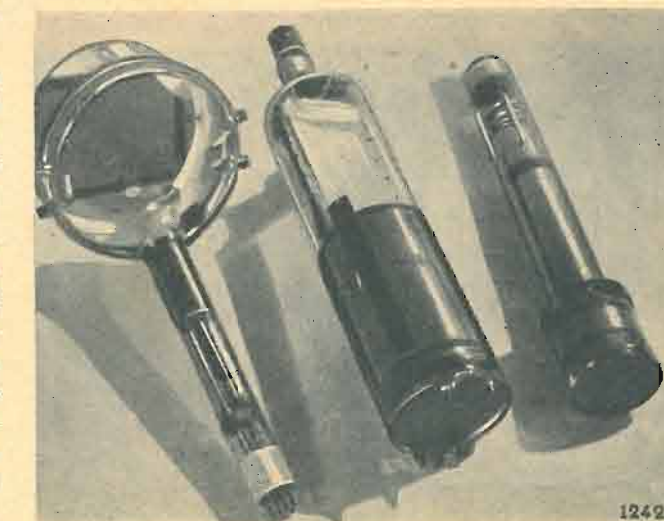
Fig. 1. - Da sinistra a destra: a) Iconoscopio di Zworykin; b) Orticonoscopio; c) Orticonoscopio a immagine elettronica. Dal raffronto delle tre fotografie risulta evidente la riduzione progressiva delle dimensioni del fotocatodo e la possibilità di usare obiettivi di sempre minor lunghezza focale.
